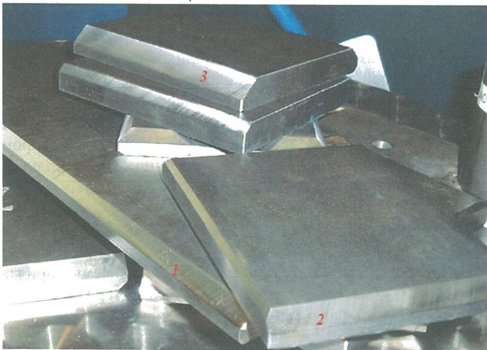
Рис. 31. Кромка разделки без абразивной зачистки (1, 2) и после зачистки (3)
