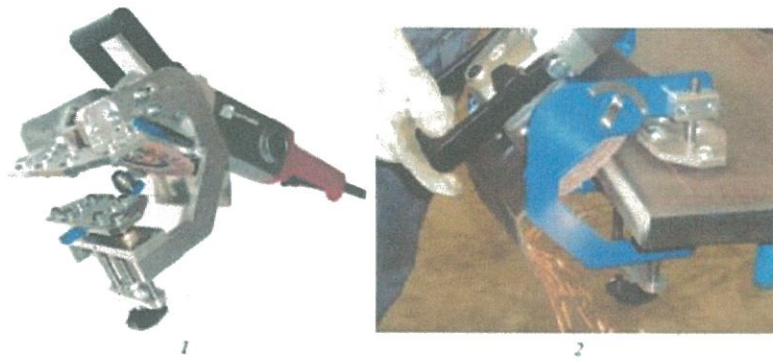
Рис. 29 Резка скоса кромки абразивными кругами: 1 – специальная переносная углошлифовальная машинка, 2 – процесс резки
